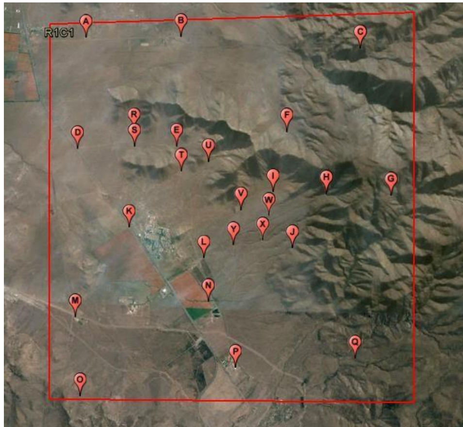
Ilustración 5.2. Puntos de Control - Rectificación
